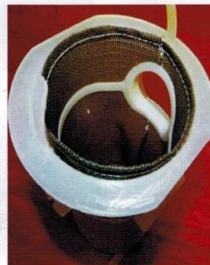
La poche souple s'insère à l'intérieur du panier et est maintenue par un collier semi-rigide.
