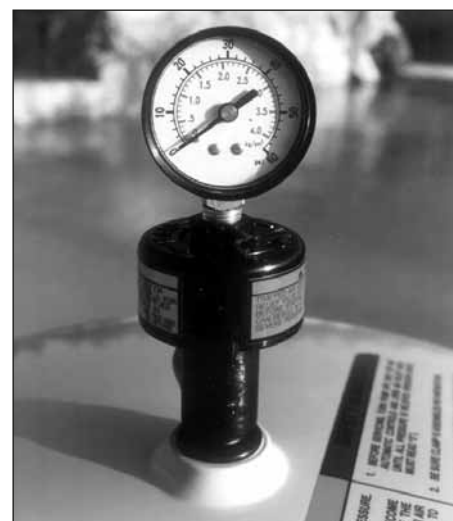
Manomètre de contrôle de l'encrassement
